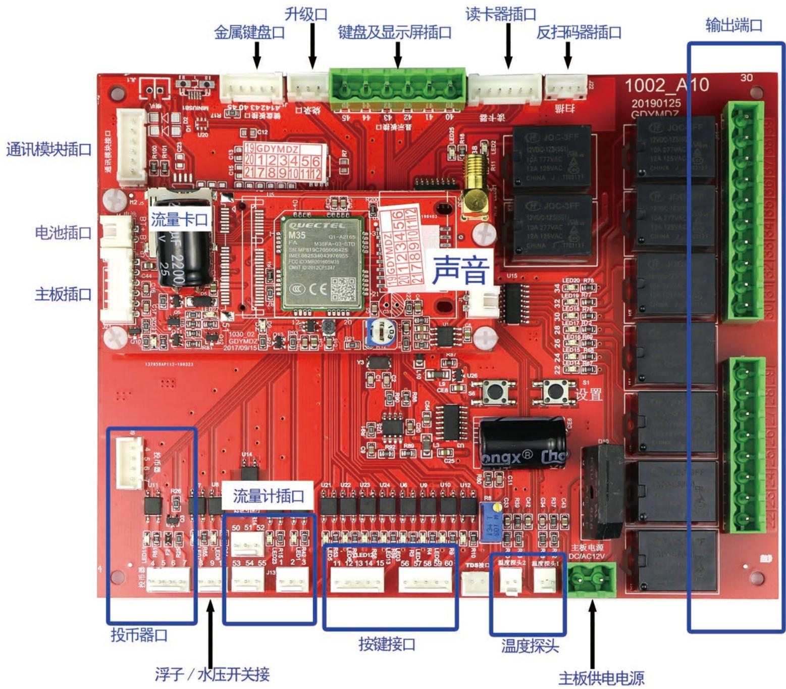
注：电池、通讯模块、金属键盘、升级工具、反扫码器、喇叭是配好线的，其余端口接线，看详细接线部分
